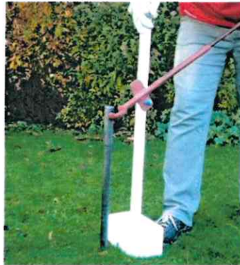
Ziehvorgang des Bohrstocke
